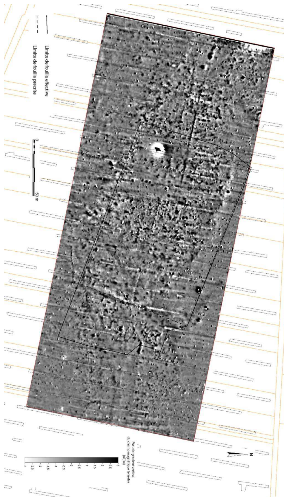
Figure 83 : Carte du pseudo-gradient vertical de l'intensité du champ magnétique terrestre, les grandes anomalies y sont estompées et les petites mises en exergue par cette configuration de mesure. (fond F. Fleischer)
