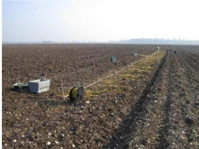
**Figure 18 : Mise en œuvre du panneau électrique sur le site de Sainte-Croix-en-Plaine**
