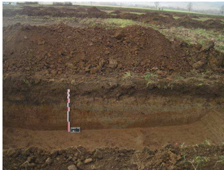
Figure 151 : Vue d'un profil de podzols avec au milieu les niveaux de sables lessivés clairs (clichés F. Bonvalot)
