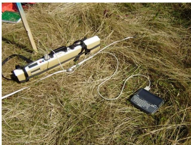
**Figure 24 : Le conductivimètre-susceptibilimètre CS60 (Laboratoire Sisyphe)**
