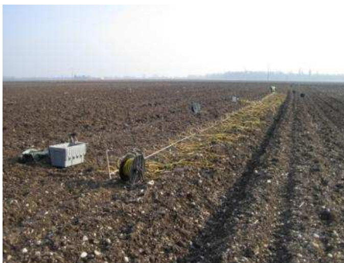
Figure 18 : Mise en œuvre du panneau électrique sur le site de Sainte-Croix-en-Plaine
