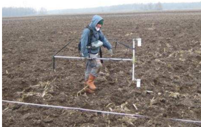
Figure 22 : Magnétomètre à vapeur de Césium, G-858 (Geometrics) en mode pseudo-gradient vertical
