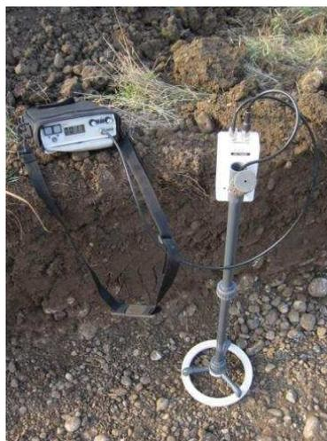
**Figure 25 : Le susceptibilimètre MS2-D (Bartington)**
