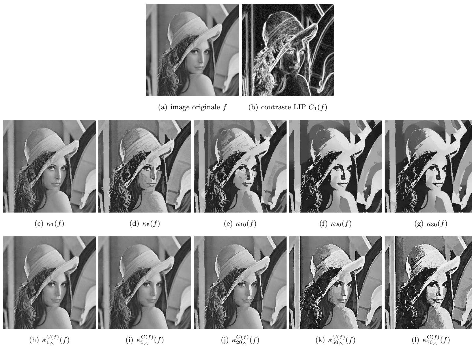
FIGURE 11.1 – Rehaussement de l'image 'Lena' (a) par contraste morphologique usuel (c-g) et contraste morphologique adaptatif (h-l) en utilisant un critère de contraste (b).
