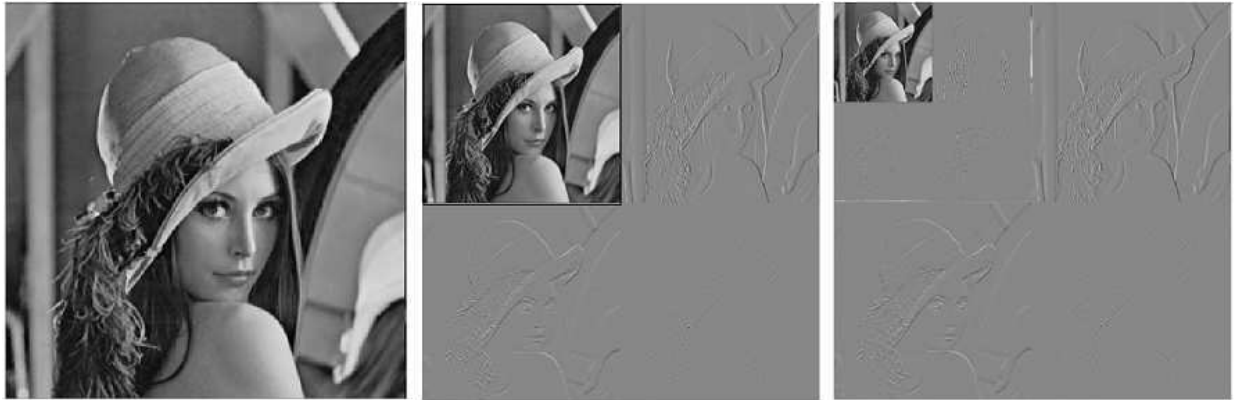
FIGURE 3.8 – Transformées dyadiques par ondelettes de Haar réalisées sur l'image 'Lena'. Deux itérations successives sont représentées, révélant les images de détails horizontaux, verticaux, diagonaux et l'image simplifiée, aux résolutions correspondantes.
