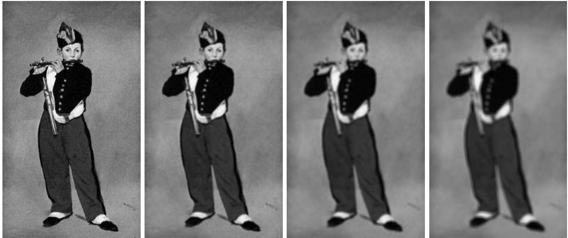
(a) image originale f (b) filtre moyen : \text{Moy}_1(f) (c) filtre moyen : \text{Moy}_2(f) (d) filtre moyen : \text{Moy}_3(f)
