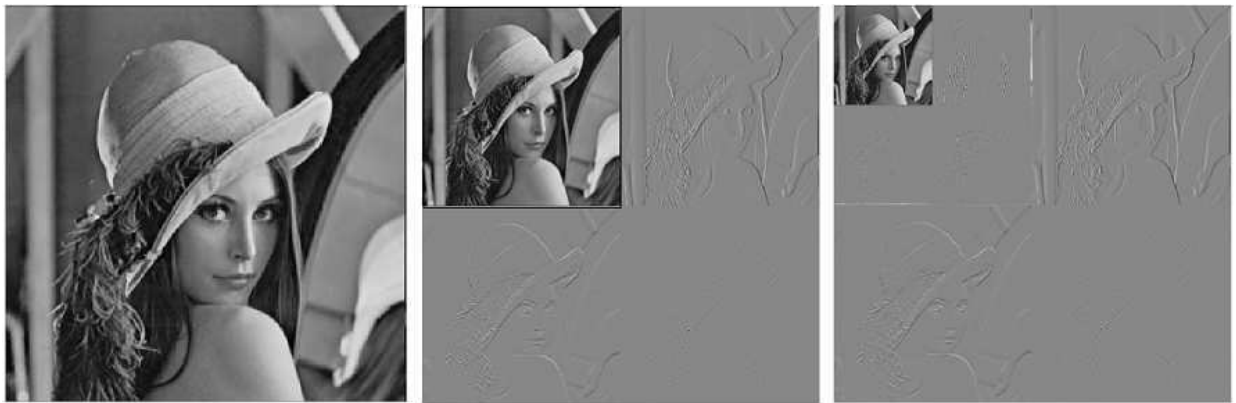
FIGURE 3.8 – Transformées dyadiques par ondelettes de Haar réalisées sur l'image 'Lena'. Deux itérations successives sont représentées, révélant les images de détails horizontaux, verticaux, diagonaux et l'image simplifiée, aux résolutions correspondantes.
