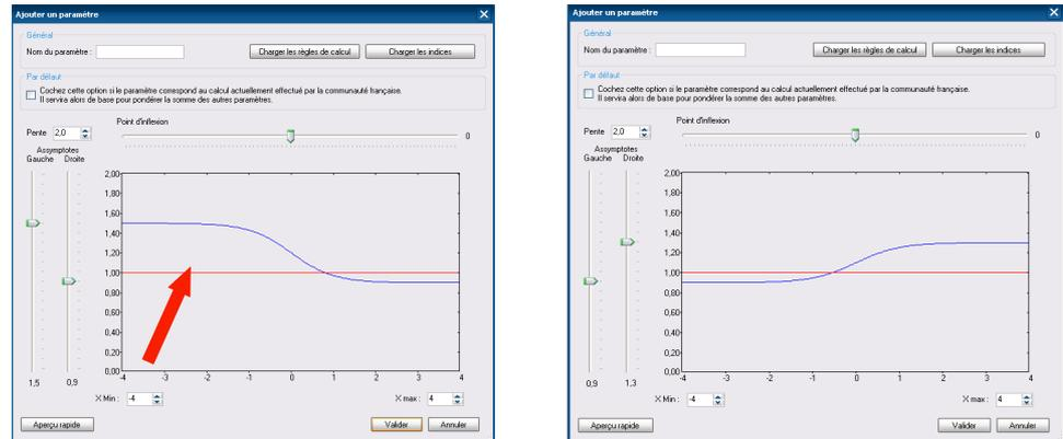
Figure 14 - La fenêtre de paramétrage de l'outil de simulation: exemple d'une courbe décroissante (à gauche) et d'une courbe croissante (à droite)
