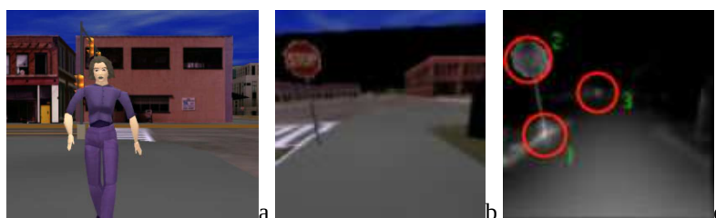
FIG. 4.12: Utilisation de carte de saillance en environnement urbain. Les mouvements de locomotion de l'humanoïde sont générés de manière arbitraire, par contre, les mouvements de la tête et des yeux sont générés automatiquement par asservissement visuel afin de se focaliser sur les zones les plus saillantes. L'image (a) montre l'humanoïde se déplaçant dans son environnement, l'image (b) montre sa perception de l'environnement et finalement, l'image (c) montre le résultat du calcul des cartes de saillance avec les trois points les plus saillants.
