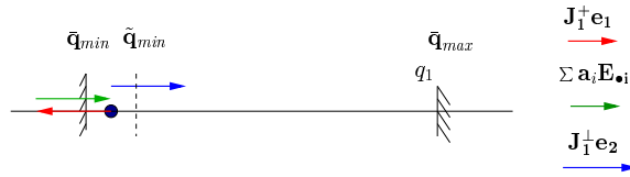
FIG. 3.9: Évitement des butées par notre approche itérative avec introduction d'une tâche secondaire.
