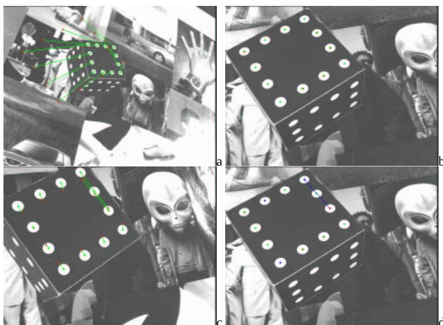
FIG. 3.13: Tâche classique de positionnement en considérant une loi de commande classique et une loi de commande robuste. L'image (a) montre l'image initiale acquise avant le début de la tâche. Les trois autres images correspondent aux images acquises à l'issue de la tâche de positionnement : (b) correspond à un positionnement reposant sur une loi de commande classique mais sans données aberrantes (expérience de référence), (c) reprend la même loi de commande classique mais la mise en correspondance entre points courants et désirés est faussée introduisant des données aberrantes (c'est un des cas d'erreurs possibles, mais d'autres cas sont envisageables [39, 137]. Comme on peut s'y attendre la commande converge vers un minimum local, (d) considère la même expérience mais avec une loi de commande robuste. Malgré les données aberrantes, la tâche de positionnement se déroule correctement.
