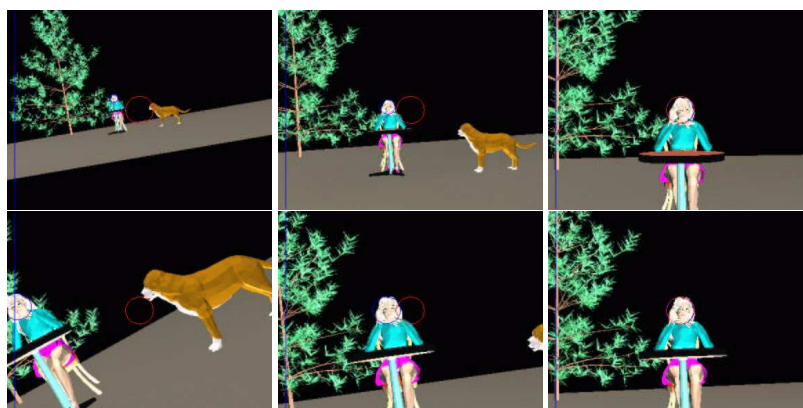
Fig. 4.1-b: En spécifiant différemment la tâche "je veux voir l'arbre vertical sur la gauche (ligne bleue) et la tête de la jeune femme assise (schématisée par une sphère) dans le cercle rouge au centre de l'écran", cinq degrés de liberté sont alors contraints (en particulier la distance par rapport au personnage est imposée).
