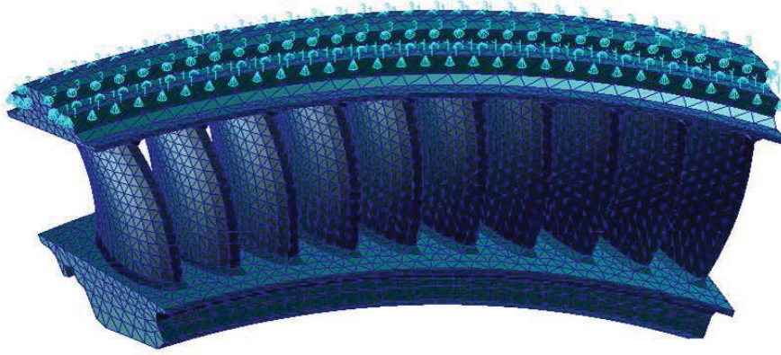
FIGURE 2.2 – Redresseur sectorisé de 10 pales du 1er étage du compresseur CREATE (version 2-bis)
