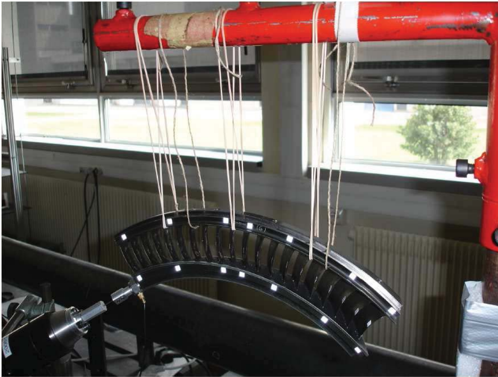
FIGURE 2.12 – Redresseur RD1 à 20 pales suspendu au bâti par des élastiques
