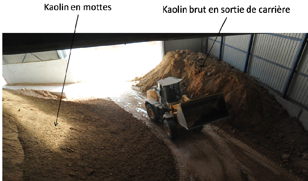
Figure III. 3 : Hangar de stockage avec à droite le kaolin brut en sortie de carrière et à gauche le kaolin après émottage
