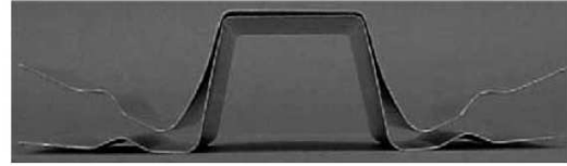
FIGURE 2.7 – Springback d'un « U-bending ».
