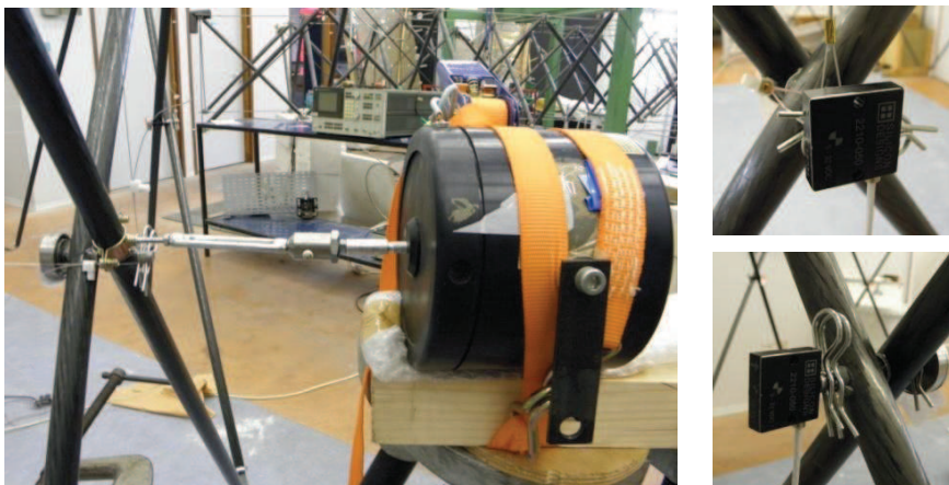
Figure 3-32 : montage expérimental avec l'accéléromètre
