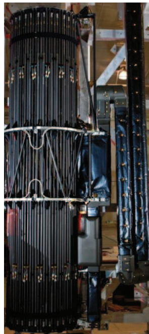
Figure 3-49 : réflecteur AstroMesh plié avec son dispositif de maintien
