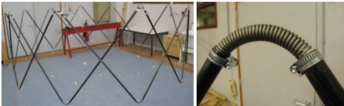
Figure 3-20 : démonstrateur avec articulations en ressort
