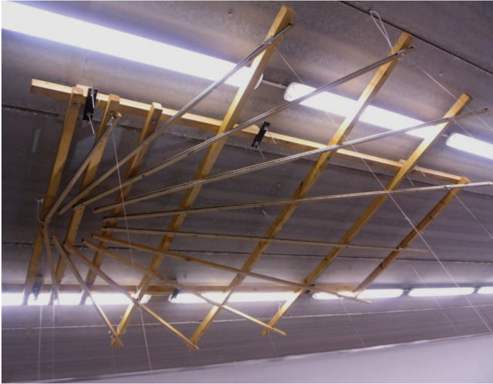
Figure 3-16 : dispositif de compensation gravitaire
