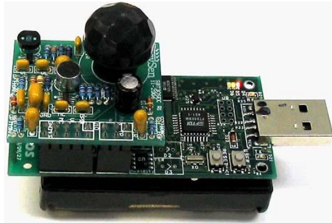
Figure 2.3: La carte électronique supérieure est le capteur EasySen et la carte inférieure est le capteur sans fil TelosB [EWSB09]
