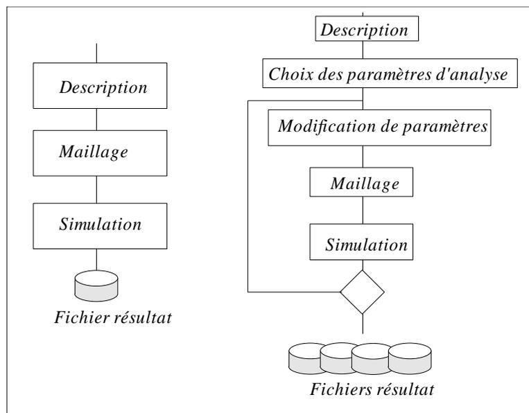
Figure 26 : Parallèle entre simulation et analyse d'incertitude automatique
