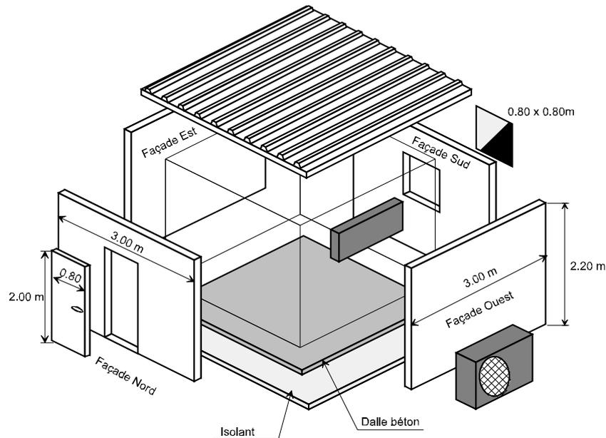
Figure 10 : Perspective isométrique de la cellule
