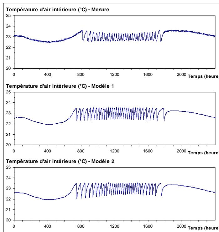
Figure 6 : Evolution de la température sèche d'air pour un pas de temps de 1 minute -
