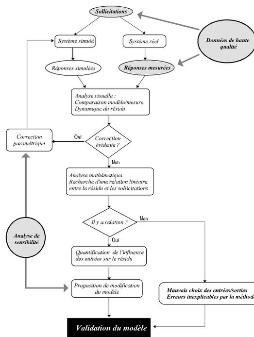
Figure 15 : Synoptique de la méthodologie de validation
