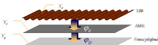
Figure 12 : Schéma d'un complexe de toiture
