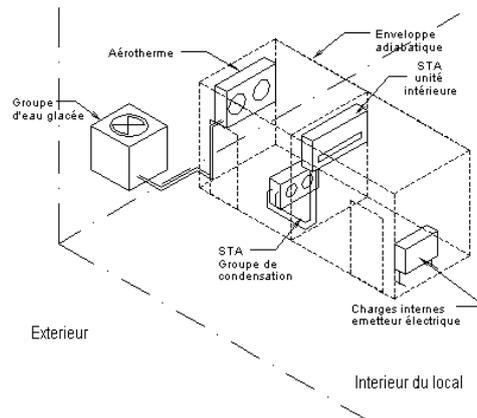
Figure 14 : Schéma de principe de l'installation
