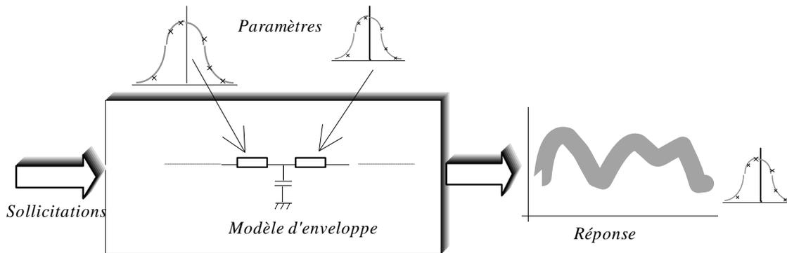
Figure 27 : Le principe de l'analyse paramétrique MCA
