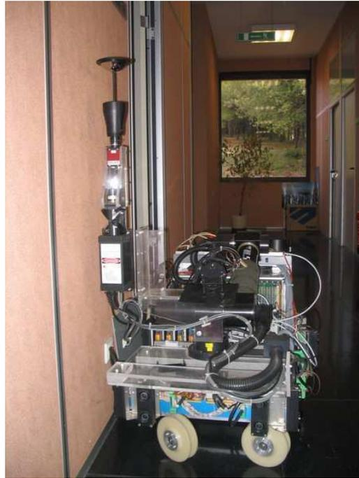
FIGURE 5.5 – Photographie du robot ANIS — On peut voir les deux roues avant (roues folles en plastique avec une surface de contact très faible) ainsi que le montage vertical de la caméra omnidirectionnelle.
