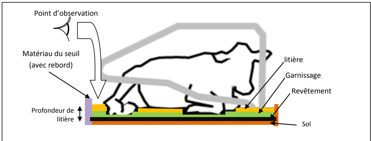
Fig. 53. Nature du sol, nature et profondeur du garnissage, de la litière, et matériau du seuil de la logette creuse
