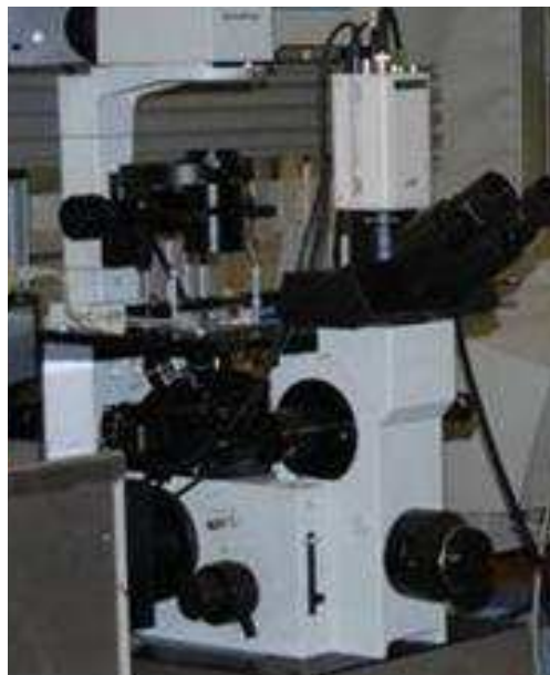
Figure 5.13 : Microscope optique Olympus IX70 à objectif inversé (Laboratoire de Rhéologie, UJF-Grenoble)
