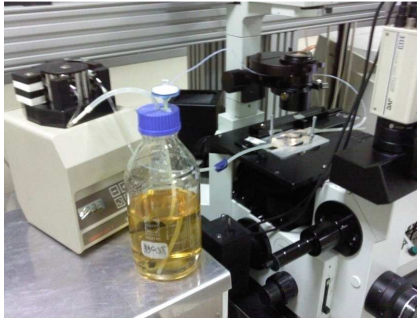
Figure 6.1 : Système d'écoulement pour le développement de biofilm. Pompage par pompe péristaltique
