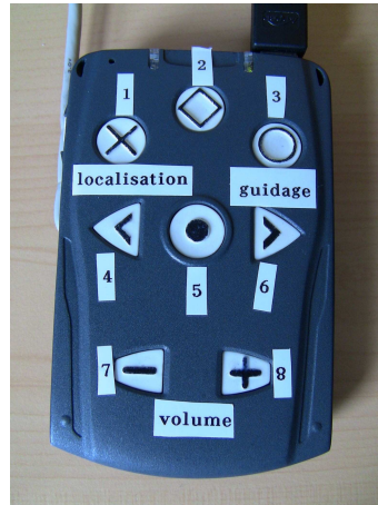
FIGURE B.4 – Photo du boîtier utilisé pour gérer les interactions basiques du système NAVIG.
