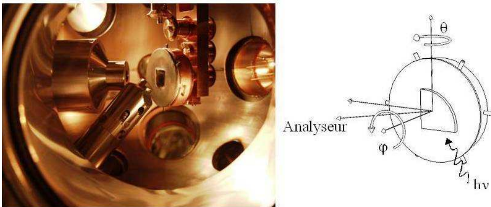
Figure 2.8: Côté gauche : photographie de l'intérieur de la chambre d'analyse montrant le nez de la source X, l'entrée de l'analyseur, le manipulateur et le porte échantillon (Molyblock Riber). Côté droit : description de la géométrie du dispositif expérimental d'analyse par photoémission.
