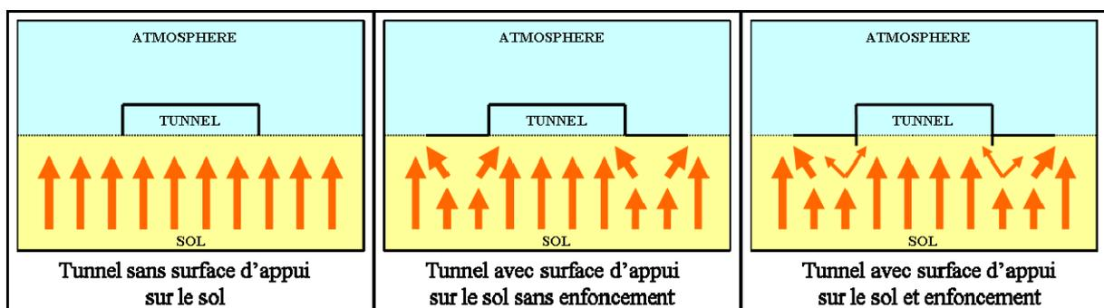
Figure 44. Influence de la surface d'appui du tunnel sur l'émission
