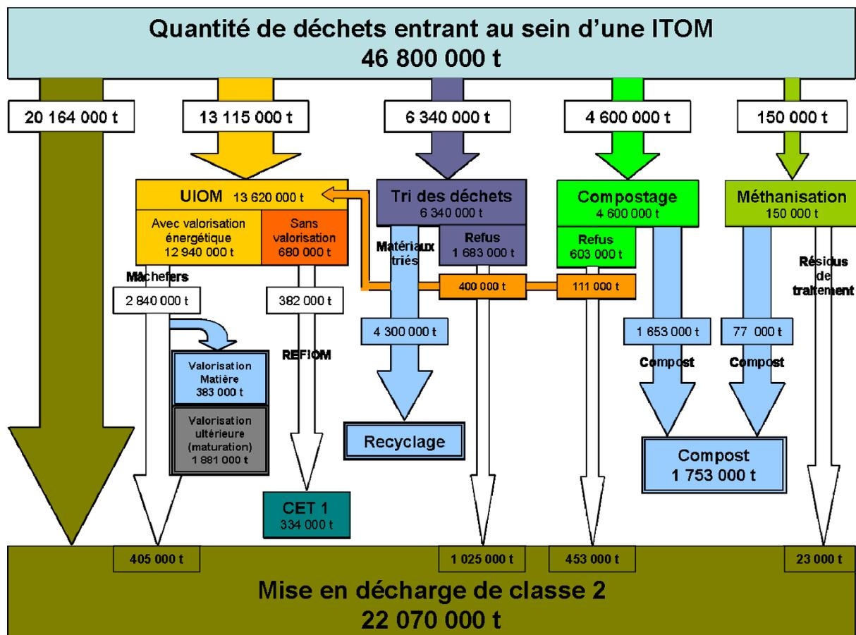
Figure 2. Synoptique des principaux flux de DND traités en 2004 (source : ADEME) (ITOM : installation de traitement des ordures ménagères ; UIOM : unité d'incinération d'ordures ménagères ; REFIO : Résidus d'épuration des fumées d'incinération d'OM)
