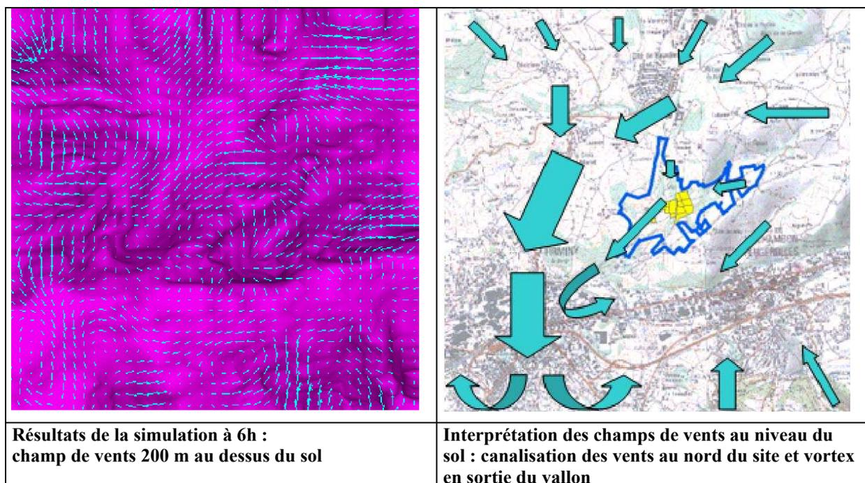
Figure 52. Champ de vents nocturnes pour un gradient de température potentielle de  $3,6^{\circ}\text{K}/\text{km}$
