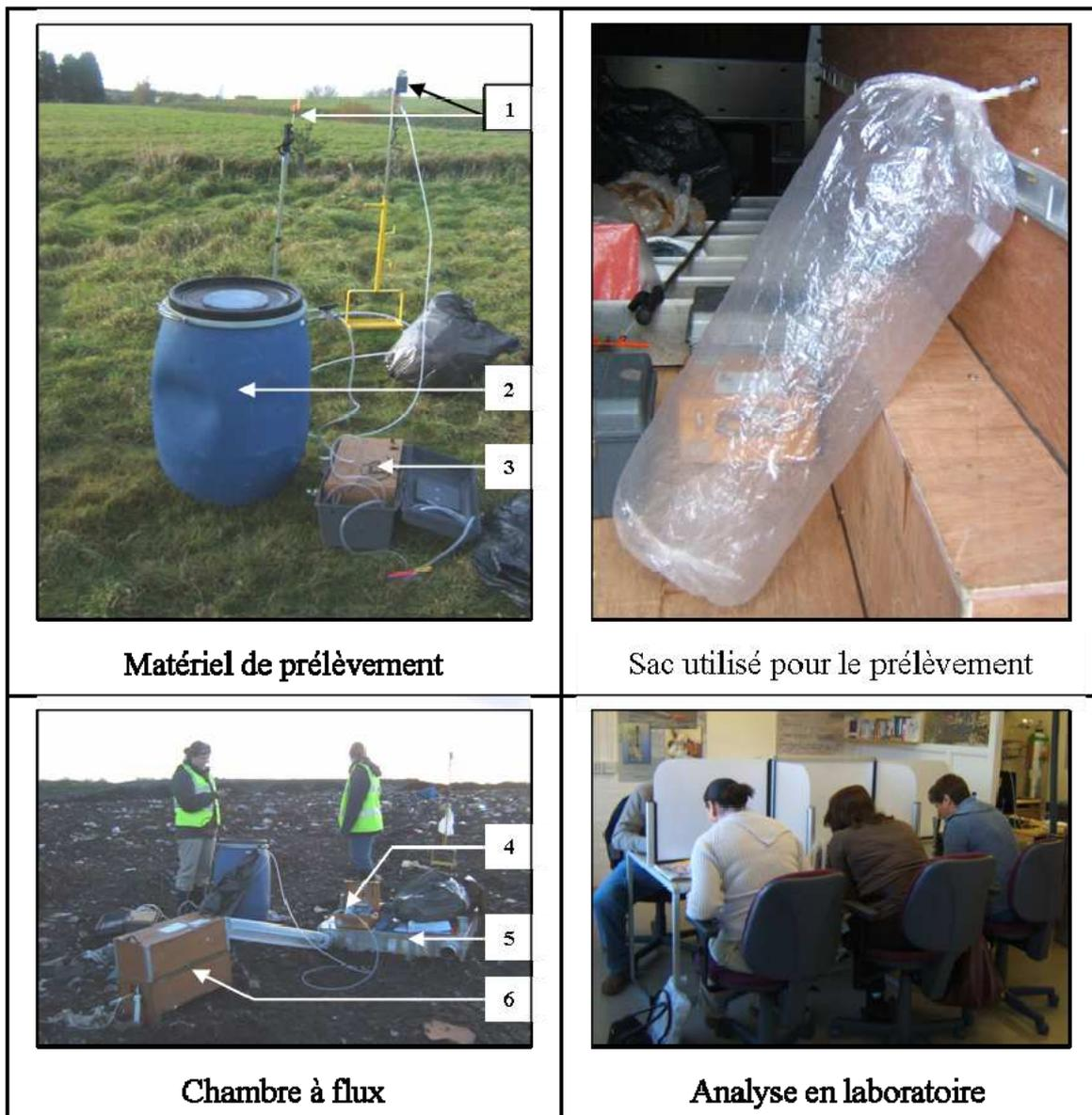
Figure 47. Matériel utilisé pour les mesures d'émissions surfaciques d'odeurs : 1. Anémomètre et girouette ; 2. Récipient étanche permettant de remplir le sac utilisé pour le prélèvement par mise en dépression ; 3. Pompe à vide ; 4. Point de prélèvement en entrée ; 5. Tunnel de vent ; 6. Ventilateur et filtre à charbon actif injectant un air propre dans le tunnel.
