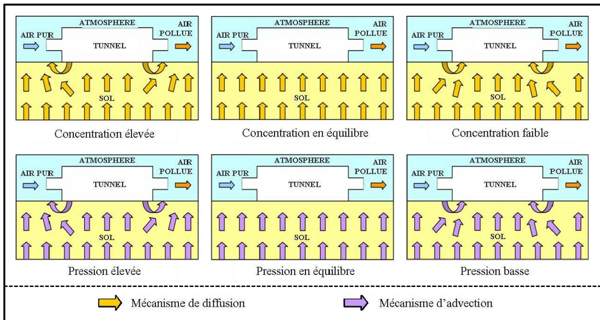
Figure 27. Influence du tunnel sur les mécanismes de diffusion et d'advection
