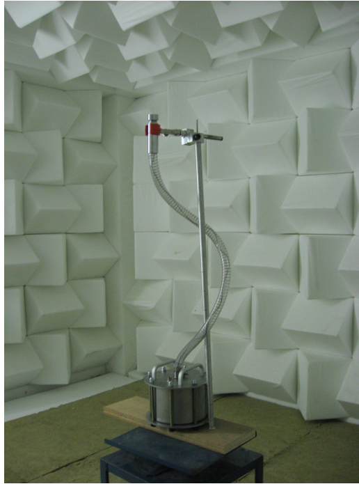
FIGURE 6.6 – Chambre de compression simulant un monopôle acoustique
