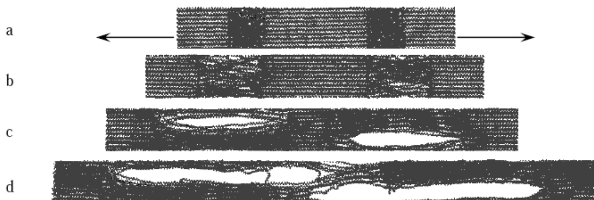
Fig. I.18 – Evolution d’un système semi-cristallin au cours du temps par dynamique moléculaire : (a) état initial, (b) \lambda = 0.2 , (c) \lambda = 0.5 , (d) \lambda = 1 (Monasse et al., 2008)
