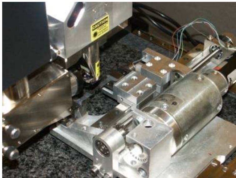
Fig. III.1 – Machine de traction in situ placé dans le microscope
