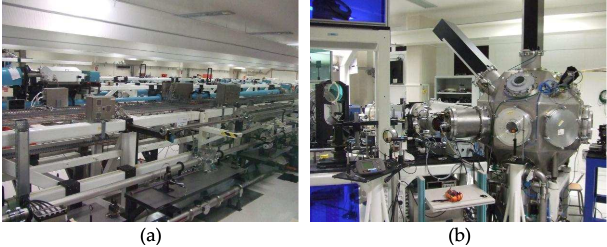
Figure II-3: Photographies des installations LULI 2000: (a) hall d'amplification d'une chaîne, (b) salle d'expérience disposant d'une chambre à vide de 1,5 m de diamètre.
