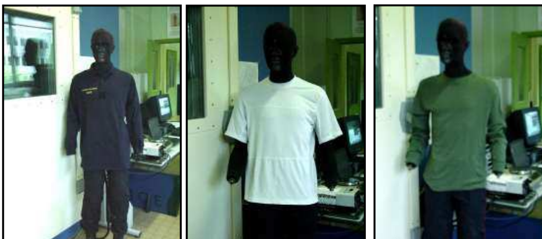
Figure 2.7 : Mannequin équipé d'un polo F1 ML de référence (à gauche), d'un échantillon MC (au centre), d'un échantillon ML (à droite) (Photos CEB)
