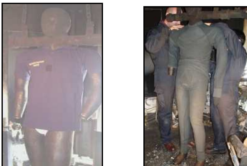
Figure 3.20 : Mannequin vêtu de sous-vêtements courts (à gauche) et longs (à droite) (Photos BSPP)
