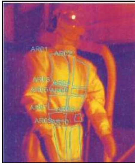
Figure 3.4 : Températures mesurées avec la camera thermographique (Photo Empa)
