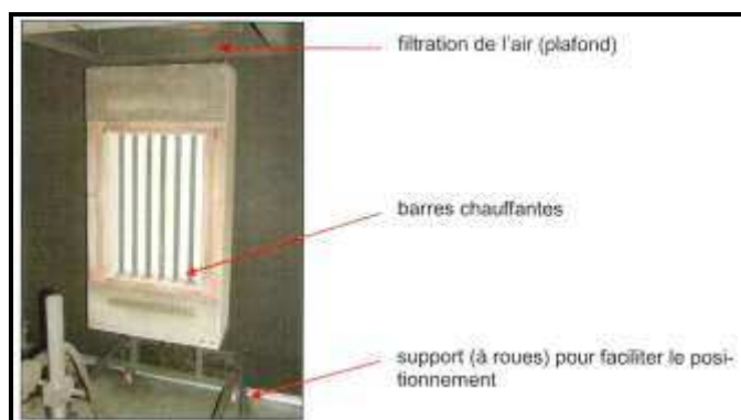
Figure 3.3 : Source de chaleur radiante (Photo Empa)
