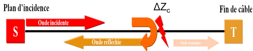
Figure 1.6 – Le principe de la réflectométrie.
