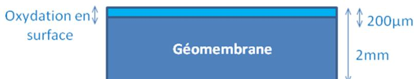
Figure IV-20 : Schématisation de l'oxydation en surface de la géomembrane
