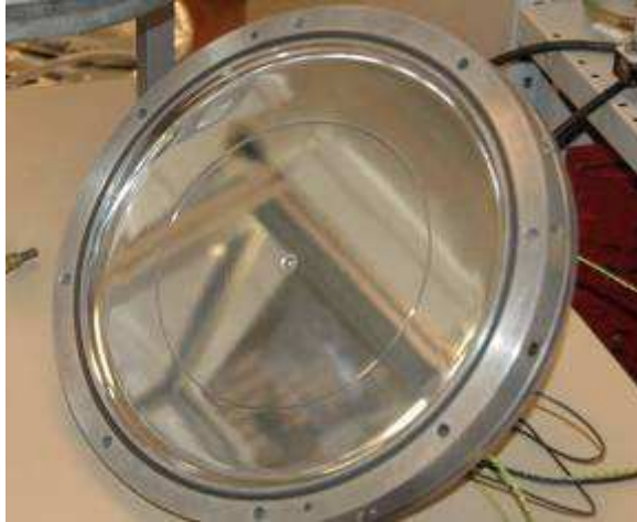
Figure 2.10 : Face interne de la plaque supérieure du SMTC, avec la fente d'injection de l'aérosol
