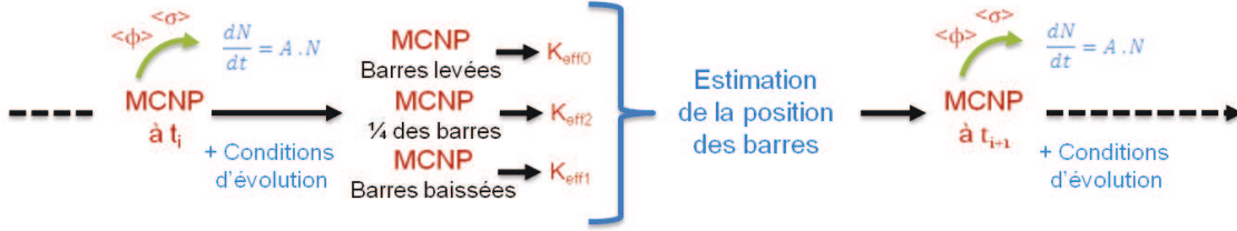
Figure 3.2: Schéma de principe d'une simulation MURE avec gestion des barres de contrôle
