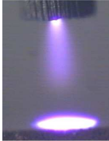
Figure 1.4 : Image d'un glow atmosphérique dans l'air extraite de Staack et al. 5 . Cathode en bas, anode en haut, distance inter-électrode de 1 mm. U = 505 V. I de l'ordre de 1 mA. P = P_{atm}
