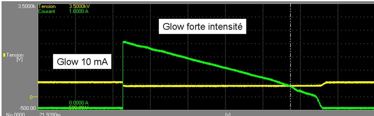
Figure 3.2 : Exemple d'évolution U(t) et I(t) pour P = 100\text{ mbar} , d = 5\text{ mm} – 5 ms/div, 200 mA /div, 800 V/div
