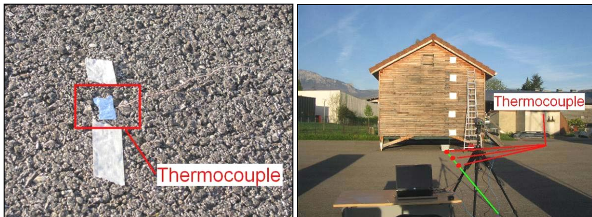
Figure 85 : Photo d'un thermocouple collé sur le bitume et positionnement des capteurs par rapport à la paroi (points rouges sur la photo de droite)
