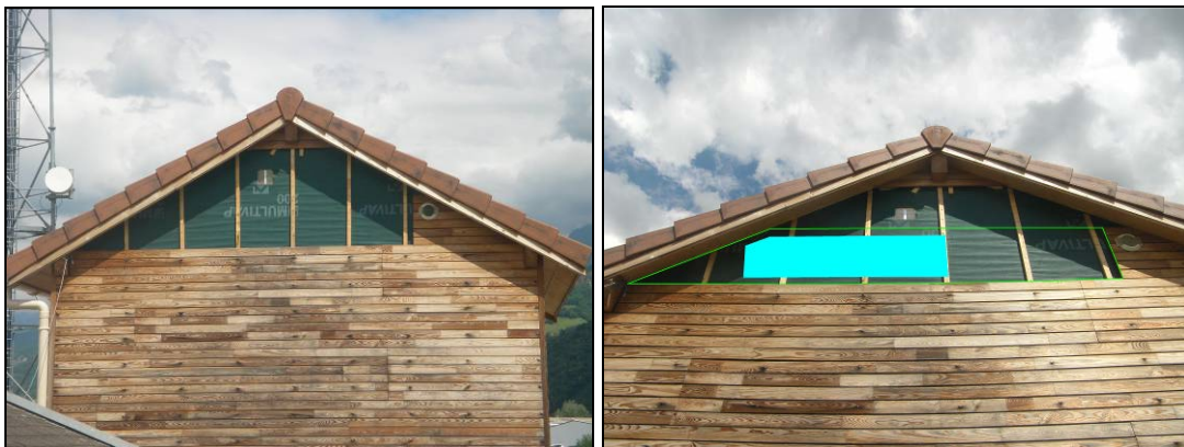
Figure 8 : Face ouest de la cellule une fois la partie supérieure du bardage démontée (gauche) et identification de la surface utilisée pour la mesure d'absorptivité (droite)
