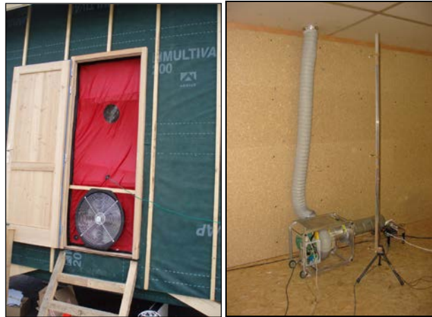
Figure 43 : Photo de la Porte Soufflante (gauche) et du Perméascope® (droite)
