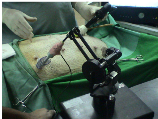
FIGURE 5.4 – Le dispositif robotique proposé par [Samur et al. 2007] utilisé dans des conditions de chirurgie mini-invasive
