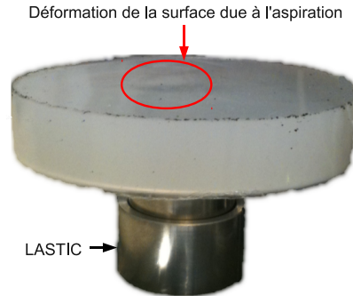
FIGURE 5.19 – Mise en évidence du décollement de la base du tissu pour l'échantillon de 15 mm d'épaisseur. L'aspiration a été faite par dessous afin de mieux visualiser.
