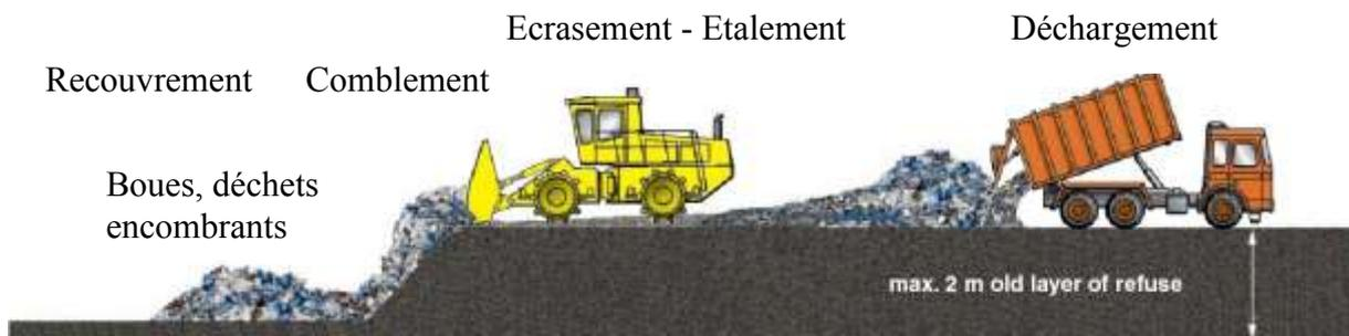
Fig. 10. Techniques du compactage des déchets (© BOMAG)
