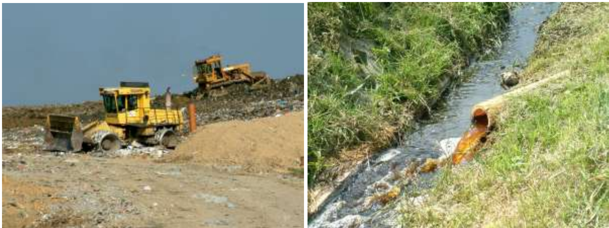
Photo 7. (A) Compacteur BOMAG en action sur le CDS Barycz (poids ~ 32 tonnes)
