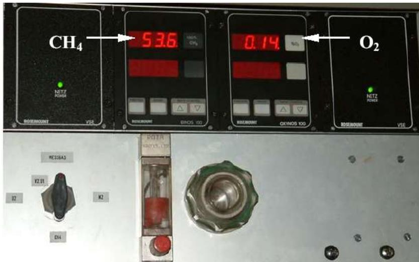
Photo 14. Panel de contrôle des analyseurs BinOS et Oxynos (© Photo M.Meres, UJ-ENSM.SE)
