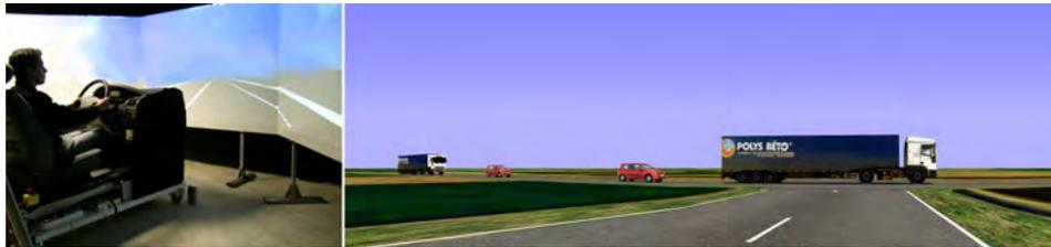
FIGURE 3.1.1 – Illustration du simulateur ARCHISIM utilisé dans nos trois expériences (à gauche) et du visuel type présenté aux participants (à droite). Il est demandé aux participants de traverser l'intersection entre les deux véhicules légers rouges.
