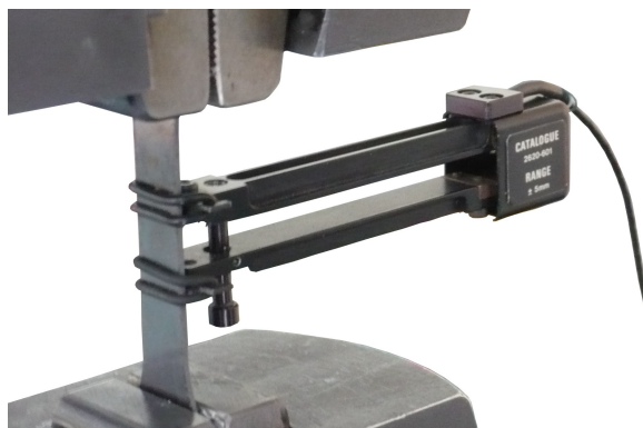
FIGURE C.1: Photographie de l'extensomètre monté pour l'acquisition du déplacement de l'éprouvette lors d'un essai de traction.
