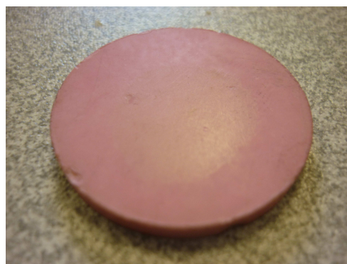
FIG. B.1 – Echantillon d'Oxyde d'Erbium fritté.
