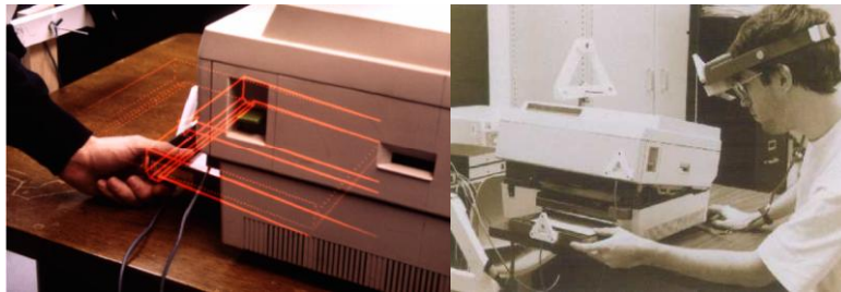
Figure 5.1 : Opérateur effectuant une tâche de maintenance en suivant les instructions virtuelles
