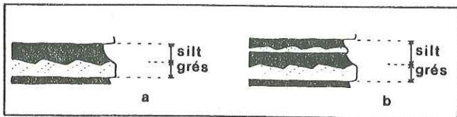
Fig. 100 - Méthode de mesure de l'épaisseur du cycle de marée, simple (a) et complexe (b)
