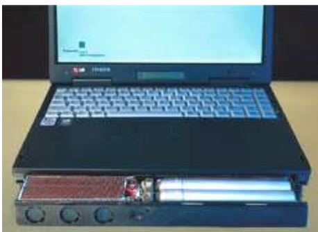
Figure a1.2.1 : ordinateur portable à PAC [Fraunhofer Institut]
