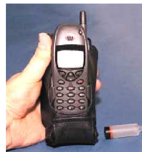
Figure a1.2.2 : téléphone portable à PAC fonctionnant au méthanol (Energy Related Devices) [ERD]
