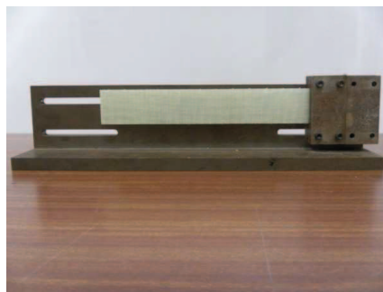
Figure 4.5. Dispositif expérimental pour évaluer l'amortissement d'une peau en matériau composite de type [0 2 /90 2 ] s .
