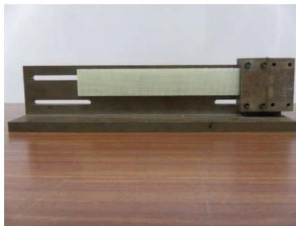
**Figure 4.5. Dispositif expérimental pour évaluer l'amortissement d'une peau en matériau composite de type [0<sub>2</sub>/90<sub>2</sub>]<sub>s</sub>.**
