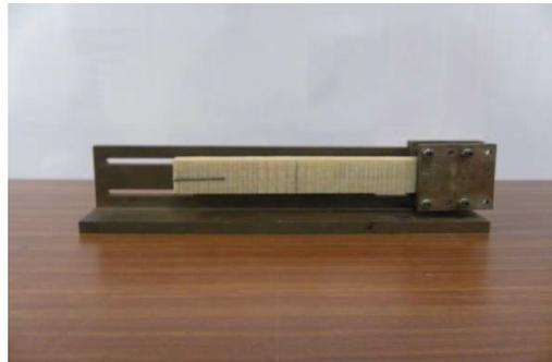
*Figure 4. 11. Poutre et encastrement utilisés pour évaluer l'amortissement d'une poutre en matériau sandwich*
