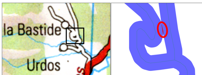
FIGURE 4.41 – Superposition de symboles routiers détectée sur les données de la Carte Régionale au 1 :150.000
