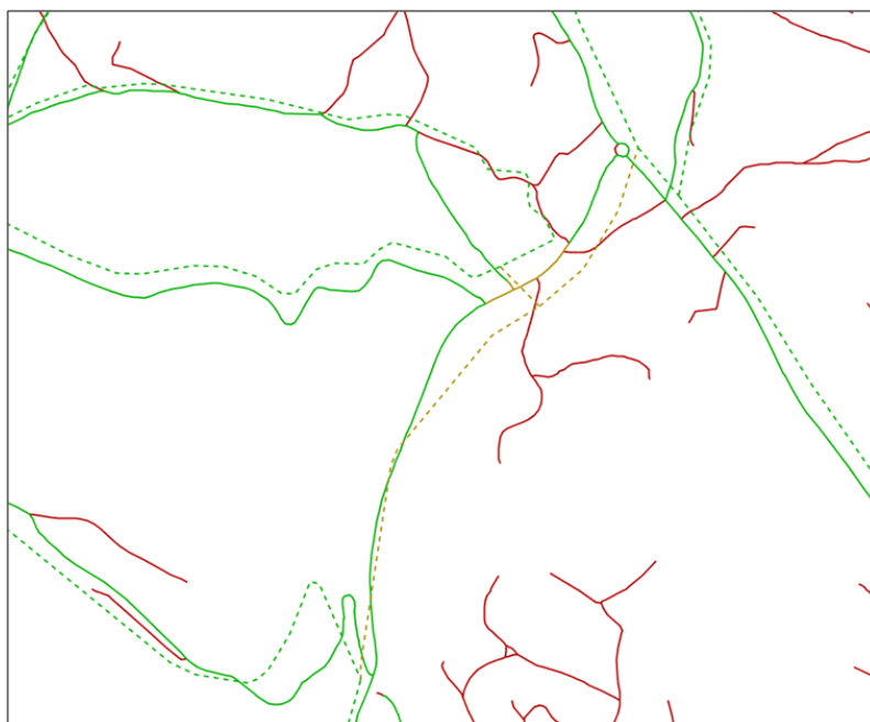
FIGURE 4.58 – Résultats d'un appariement entre les tronçons de route de la BDTPO (en trait plein) et de la BDCARTO (en tiretés) en trois classes : "Apparié" (en vert), "Incertain" (en orange), "Non apparié" (en rouge)
