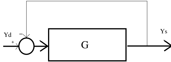
FIG. 3.3 – Schéma bloc d'un système en boucle fermée.
