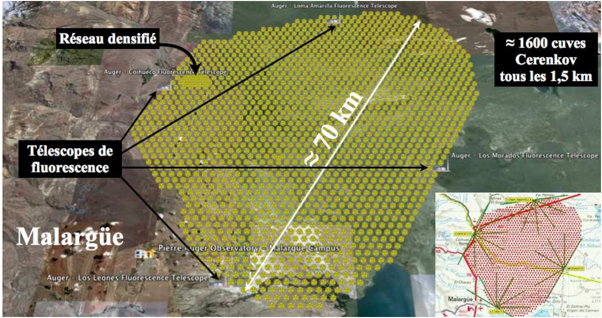
FIGURE 1.35 – Plan et dimension du site Auger (Image Google Earth). En bas à droite, l'image permet de voir l'ouverture angulaire des quatre sites de fluorescence. Chaque site dispose de six portions de télescope juxtaposés, couvrant chacune une zone de ciel au dessus du réseau Auger.
