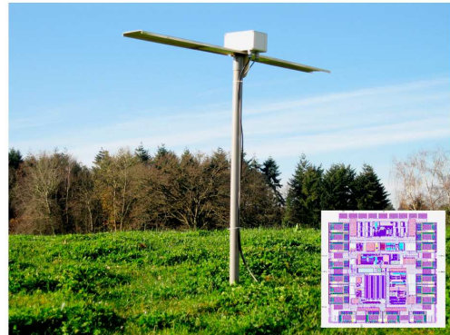
FIGURE 2.13 – Antenne dipolaire active développée par le laboratoire Subatech pour CODALEMA-II.
