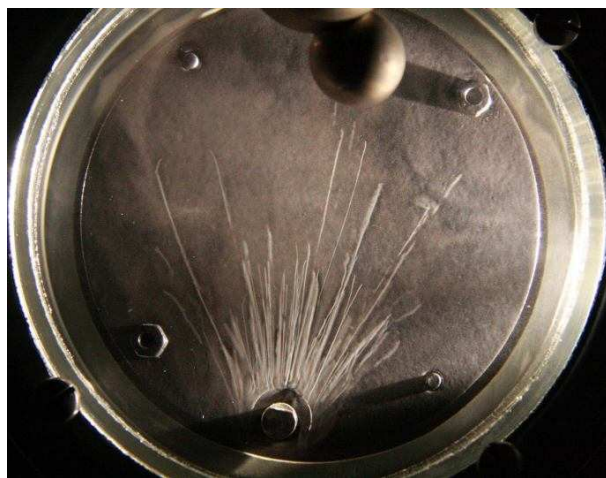
FIGURE 1.11 – Traces laissées par des particules alpha dans une chambre de Wilson.
