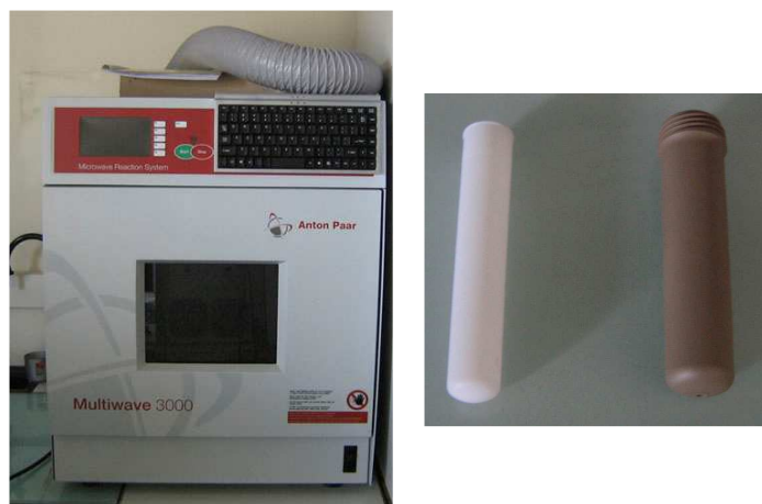
Figure II-12 : Multiwave 3000 et bombe Téflon pour micro-onde.
