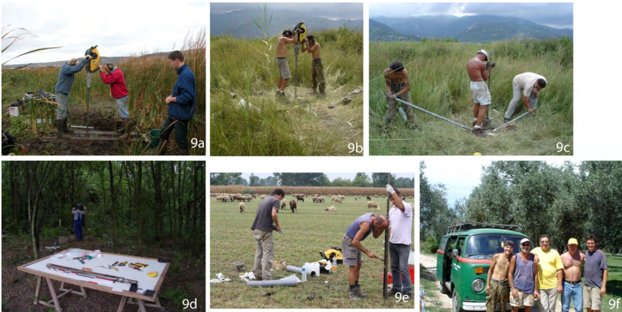
Photos 9 a à e - Les étapes du carottage avec un carottier à percussion de type « Cobra ». a et b. Percussion motorisée (Mare de Vauville, La Hague et Skala Sotiros, Thasos ; c. Extraction manuelle (Thasos) ; d. Description ; e. Nettoyage de la gouge ouverte, Philippes ; f. Equipe au Complet (Thasos, 2006). (Clichés L. Lespez)
