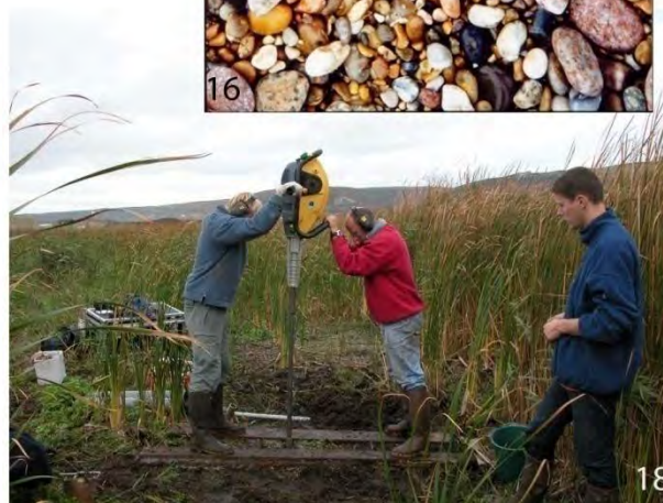
Photo 15 - Sondage à la pelle mécanique effectué sur l'estran de l'Anse Saint-Martin Photo 16 - Sondage à la tarière effectué sur le cordon de galet de l'Anse Saint-Martin Photo 17 - Carottage à la sonde russe effectué dans la vallée du Grand Douet à Biville Photo 18 - Carottage au carottier à percussion effectué dans la Réserve Naturelle Nationale de la Mare de Vauville à La Hague (Clichés L. Lespez)
