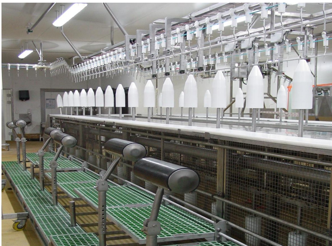
Figure 36 - Photographie des nouvelles chaînes de découpe sans opérateur.
