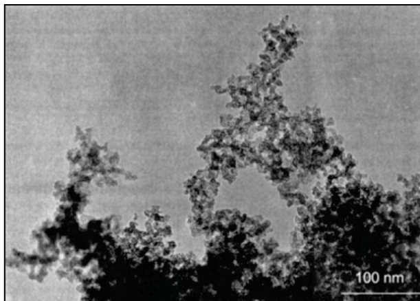
Figure 8 : Image MET d'un aérogel de carbone de densité 0,4 \text{ g.cm}^{-3}
