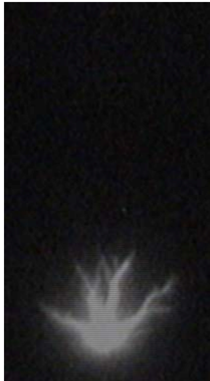
Fig. 3.36 Oscillogramme de la charge et photographie correspondant à la propagation totale d'un streamer de « 2 ème mode » pour U < U_a . D=20\text{cm} , U=168\text{kV} , l_s=51\text{mm} et v=1,7\text{km/s} .
