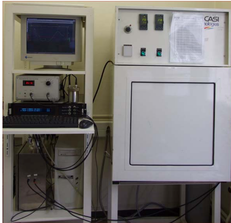
Fig. .8 Dispositifs de mesure des propriétés diélectriques et de conditionnement de l'huile
