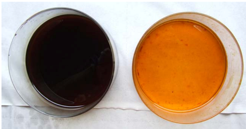
Fig. .3 Comparaison de la couleur des deux huiles apr s 15 jours   120 C (leurs couleurs initiales sont similaires) a: Huile min rale, b: Huile RS50
