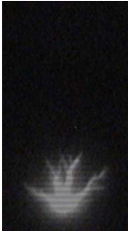
Fig. 3.36 Oscillogramme de la charge et photographie correspondant à la propagation totale d'un streamer de « 2<sup>ème</sup> mode » pour  $U < U_a$ .  $D=20\text{cm}$ ,  $U=168\text{kV}$ ,  $l_s=51\text{mm}$  et  $v=1,7\text{km/s}$ .
