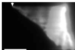
Fig. .44 Courant transitoire et photographie d'un streamer du "4 ème mode" constitué d'un saut unique se propageant jusqu'au claquage ( D = 10 cm, U = 152 kV)
