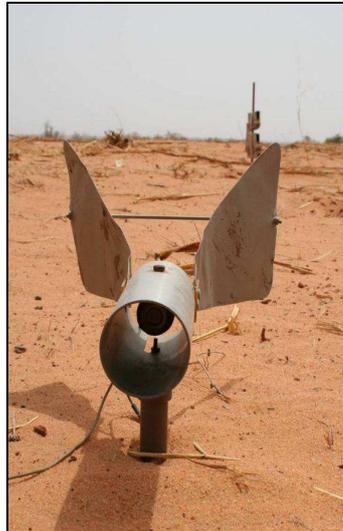
Figure 2.5 : salthophone installé sur PB (Photo : Abdourhamane Touré 2007)
