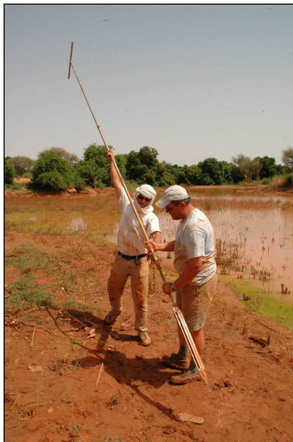
Figure 4.16 : Carottage dans Tondi Gamey avec le carottier russe (Photo : Bichet, 2008)
