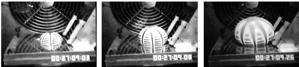
FIG. 1.3 – Trois phases de l'expérience de soufflage. Les cercles concentriques, ainsi que les méridiens sur la bulle permettent de mesurer les déformations a posteriori. Un système de miroirs est utilisé pour effectuer les mesures suivant différentes vues. Comme le montre la troisième photo, les erreurs de mesure sont assez importantes.
