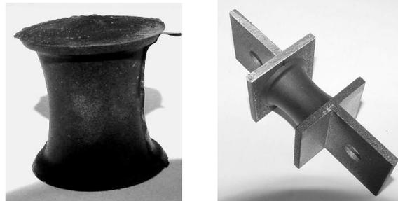
FIG. 3.10 – *Éprouvette de type diabolo : longueur 30 mm et diamètre central 20 mm. Cette éprouvette, classiquement utilisée en fatigue, permet de localiser l'initiation des fissures dans la partie centrale. Sa géométrie permet aussi d'obtenir des niveaux de déformation locaux plus importants dans cette zone centrale que le niveau de déformation global imposé.*
