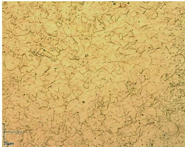
Figure 2.2 : Micrographie de la surface de l'alliage Fe-Ni-Co après attaque électrolytique.
