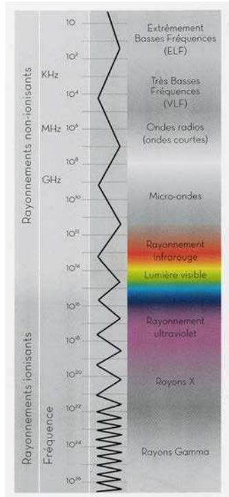
**Figure 2** – Spectres d'ondes électromagnétiques (Feterman, 2010)
