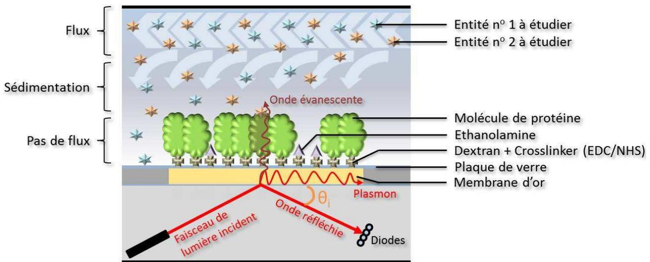
**Figure 11.1** – Schéma du fonctionnement du Biacore®
