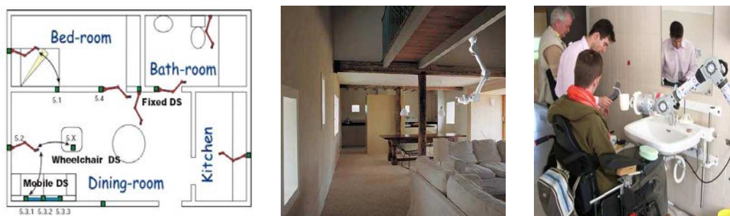
FIG. 1.13 – Le robot Mats peut se déplacer de prise en prise à l'intérieur d'une maison, se fixer sur un support fixe ou encore sur un fauteuil roulant
