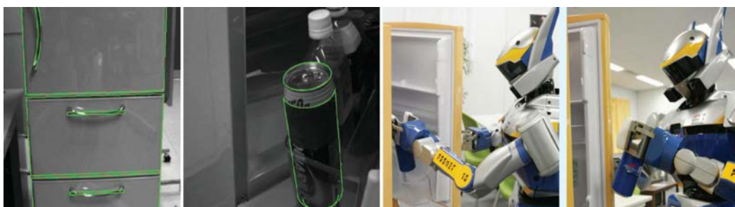
FIG. 1.18 – Le robot HRP-2 dispose d'une base de données des modèles CAO de son environnement. Le scénario consiste à détecter un réfrigérateur, à l'ouvrir et à saisir une bouteille de soda à l'intérieur. Le système connaît a priori les modèles de la canette et du réfrigérateur.
