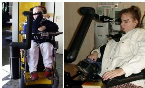
FIG. 1.12 – Le bras Manus est un bras sécurisé qui peut être commandé en utilisant un joystick
