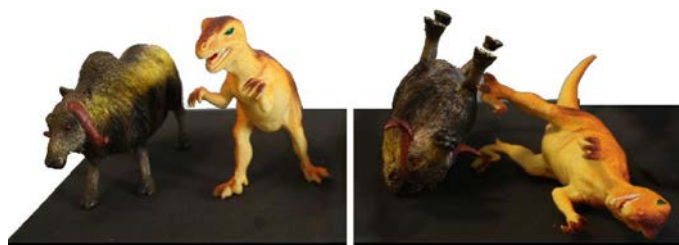
FIG. 5.4 – Si les objets sont globalement convexes et présentent uniquement quelques concavités suffisamment petites devant les dimensions de la pince, alors ces concavités ne perturbent pas la saisie. À gauche, les objets sont dans une pose favorable à la saisie, à droite, les pattes des jouets risquent de gêner l'approche de la pince.
