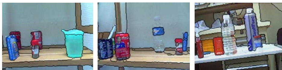
FIG. 8.4 – Segmentation reposant sur une carte de disparité et la détection de région d'une même couleur [LeCam 08].
