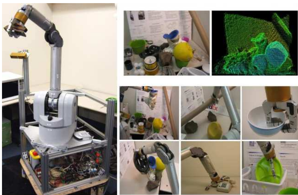
FIG. 1.22 – Saisie d'objets en connaissant partiellement leur forme [Saxena 08].
