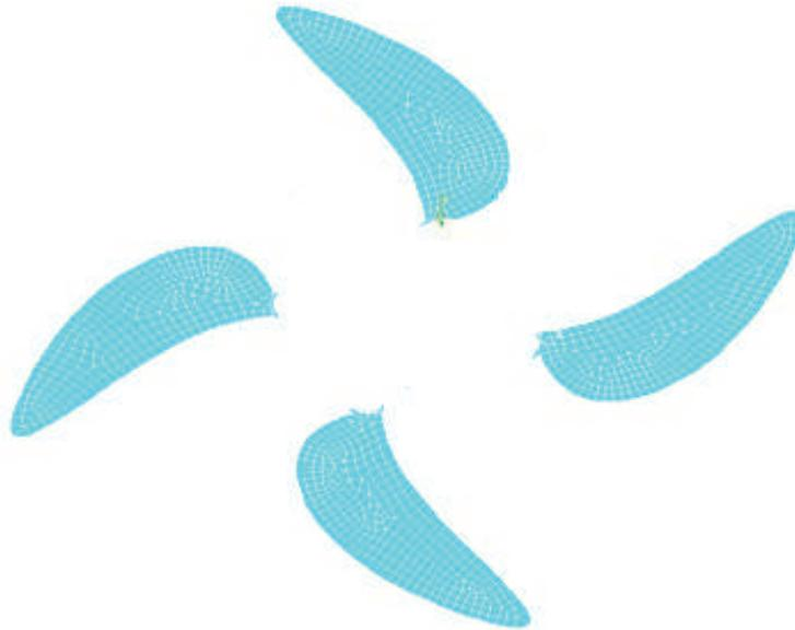
Figure A1.14 – Modèle éléments finis pour les sous-structures
