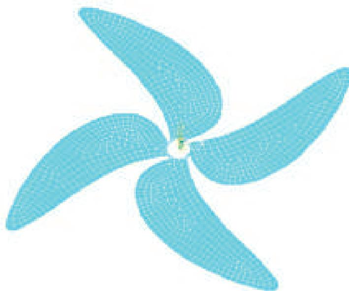
**Figure A1.13** – Modèle éléments finis pour l'hélice entière
